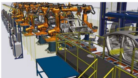
Validierung der konstruierten Fertigungsstraßen mit Process Simulate
