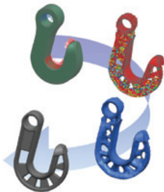
Topologieoptimierung für den Entwurf neuer Kranhaken
