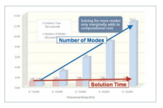
Für den obigen Fall wurden etwa 250 Modi im Bereich von 0 bis 10.000 Hz berechnet. Die Überprüfung des Verhältnisses der Anzahl der angeforderten Modi zur CPU-Auslastung hat erneut gezeigt, dass eine Lösung für mehr Modi die Kosten für die Berechnung nur geringfügig ansteigen ließ.
