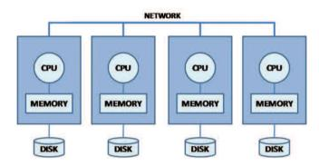
Diese Aufteilung in Bezug auf Geometrie- oder Frequenzbereich erfolgt einzeln oder gleichzeitig. Obwohl jeder Prozessor an einem eigenen Bestandteil des Geometrie- oder Frequenzbereichs arbeitet, kommunizieren die Prozessoren untereinander, um Informationen auszutauschen. Sobald die Lösung vorliegt, werden die Ergebnisse zu einer einzigen Ergebnisdatei zusammengeführt.
