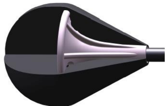
Sicherheitskopf des IDV-LARP-Pfeils
