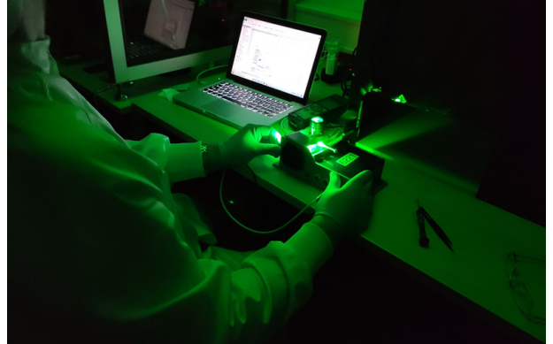
Prüfung einer DMD-Beleuchtungsoptik im Labor
