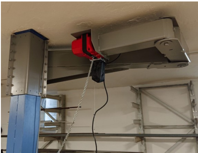
Schwenkkran mit Gelenken, die einen Arbeitsbereich von mehr als 360° um den Montagepunkt ermöglichen
