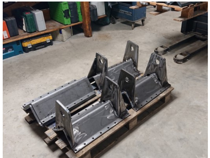
Klemmkonsole für den Schwenkkran für Hallenpfeiler
