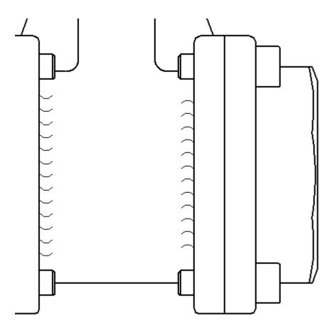
Sie können Linien auf dem Blatt und auch in Zeichnungsansichten auswählen. Die Schweißnaht wird dann entsprechend auf dem Blatt oder in der Zeichnungsansicht erzeugt.
