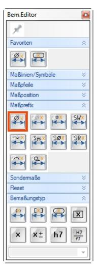
Die unterschiedlichsten Maßdarstellungen können in Solid Edge durch entsprechende Einstellungen im Bemaßungsmenü eingestellt werden. Häufig sind es mehrere Schalter, die eingestellt werden müssen, um die gewünschte Darstellung zu bekommen. Mit dem Bemaßungseditor erledigen Sie all diese Dinge mit einem einzigen Klick.
