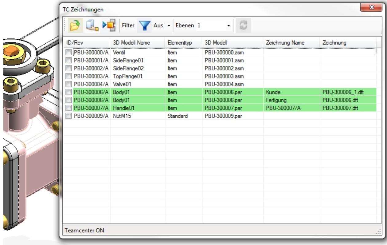
Alle Modelldateien (Part, Sheet Metal und Assembly) der Baugruppe oder die aktuelle Part oder Sheet Metal Datei werden in der Liste angezeigt.
