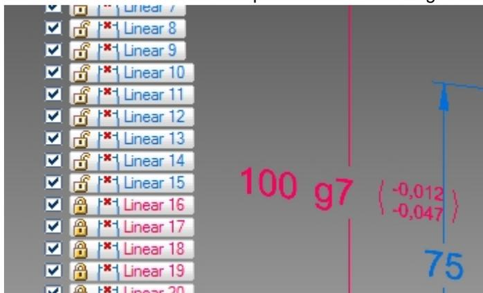
Die Zeilen mit Haken in der ersten Spalte (Filter) werden hellblau hinterlegt. Nur die Maße dieser Zeilen werden in dem erzeugten CAD Modell verändert
