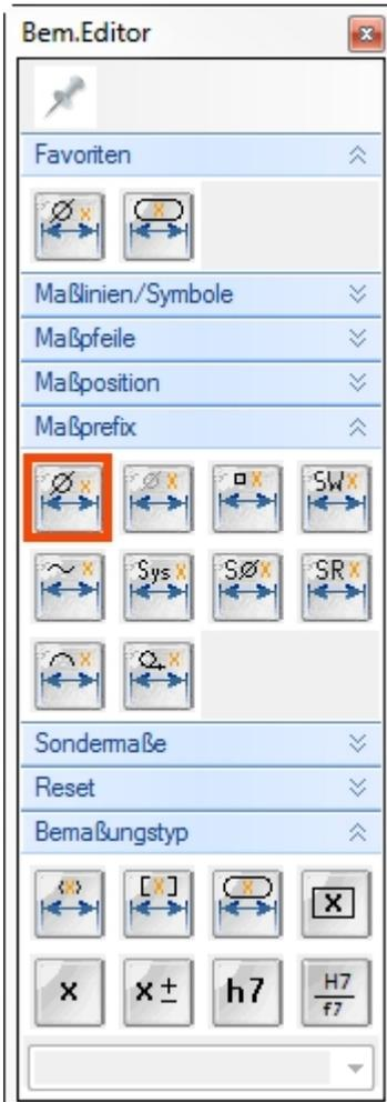
Die unterschiedlichsten Maßdarstellungen können in Solid Edge durch entsprechende Einstellungen im Bemaßungsmenü eingestellt werden. Häufig sind es mehrere Schalter, die eingestellt werden müssen, um die gewünschte Darstellung zu bekommen. Mit dem Bemaßungseditor erledigen Sie all diese Dinge mit einem einzigen Klick.
