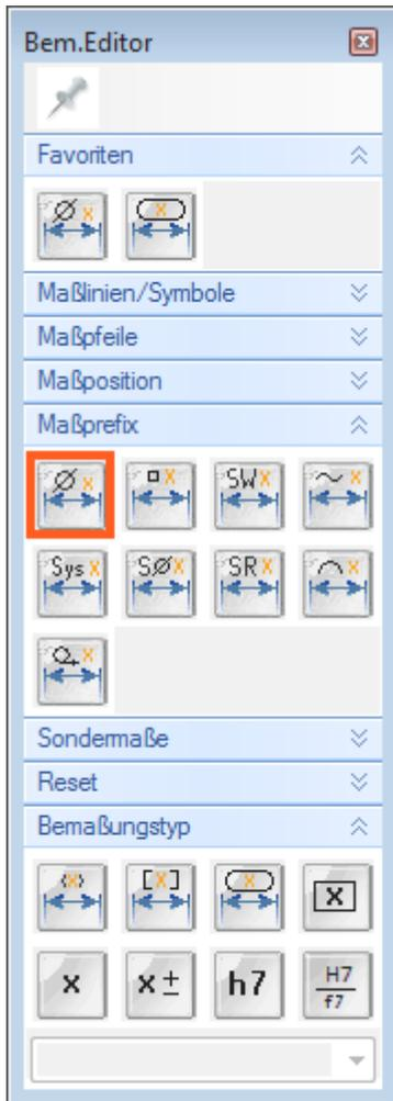
Die Funktionen sind in Gruppen zusammengefasst, die auf- und zugeklappt werden können. Außerdem kann die Breite (Anzahl der Funktionen horizontal) eingestellt werden.
